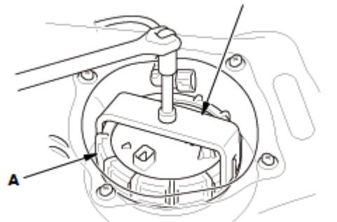
1. 使用燃油泵单元锁紧螺母扳手，拧松燃油箱单元锁紧螺母 (A)。
