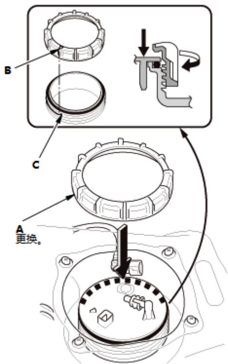
2. 使用燃油螺母扳手将锁紧螺母紧固至规定扭矩。
