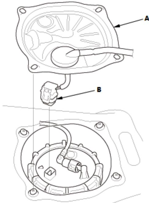
4. 燃油管路/快速连接接头 - 断开
